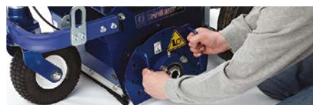
2. Schrauben und Abdeckung entfernen
