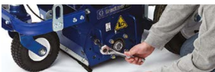
1. Vier Schrauben lösen
