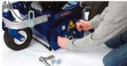
2. Schrauben und Abdeckung entfernen
