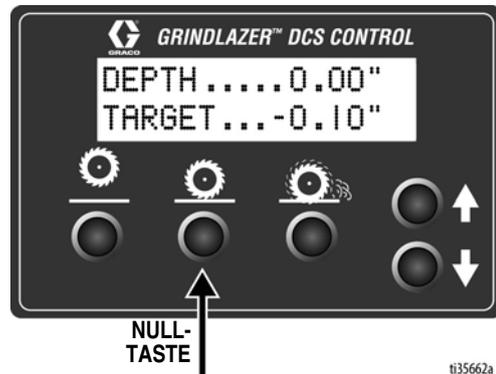
**Langes Drücken:** Der Nullpunkt zur aktuellen Schneidkopfposition wird neu programmiert.
