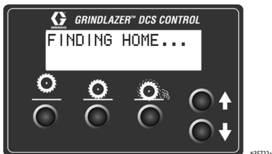
Wenn die DCS-Steuerung die Home-Stellung gefunden hat, stellen Sie sicher, dass das korrekte Modell sowie die gewünschte Sprache und Einheiten ausgewählt sind. Die Anleitung zum Ändern dieser Einstellungen finden Sie in **Menü-Bildschirme**, Seite 14.
