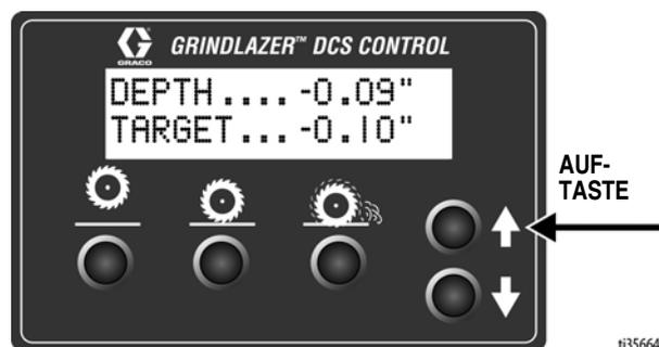
**Langes Drücken:** Der Schneidkopf wird in die Home-Position angehoben.
